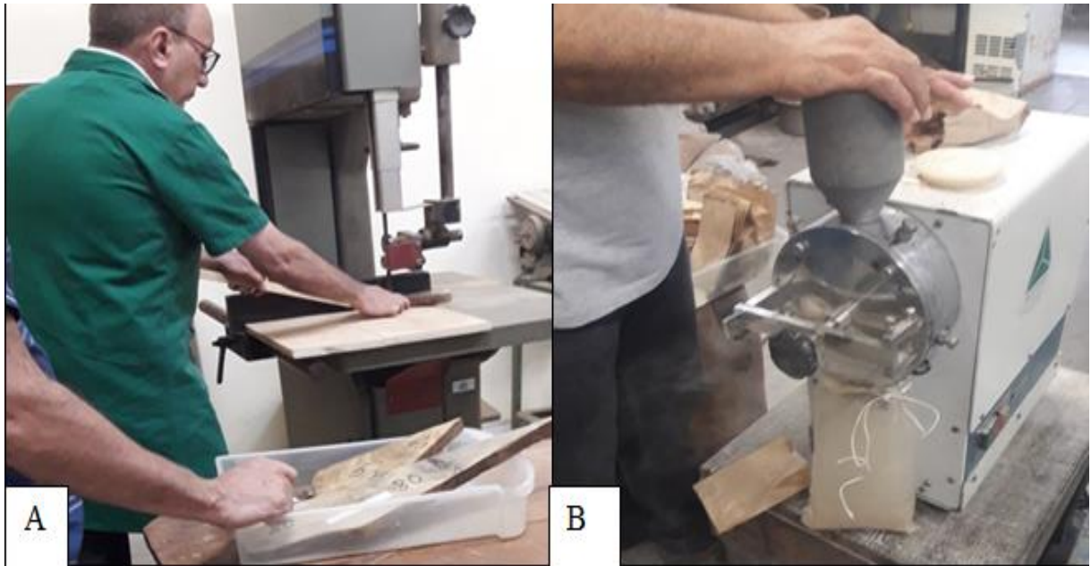
Figura 3. A. Redução das dimensões das amostras em serra de fita; B. Moagem das amostras para a produção de serragem com granulometria adequada para os ensaios de umidade e de cinza.
