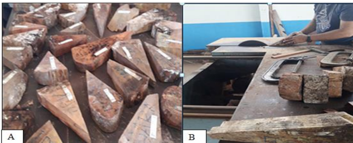
Figura 2. A. Aspecto das amostras utilizadas neste estudo; B. Corte das amostras em serra circular de bancada para produzir o material usado nos diferentes ensaios.
