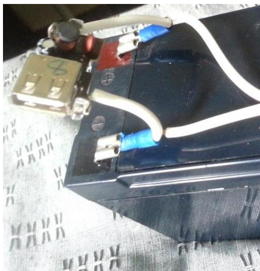
Figura 4.8 – Circuito com bateria e transformador
