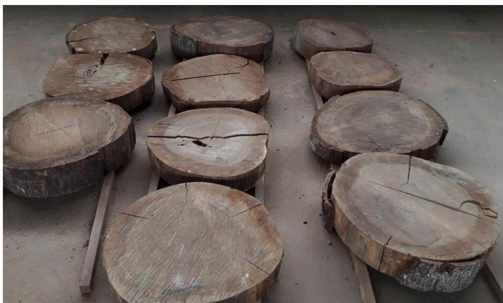
Figura 2. Distribuição das amostras para secagem em temperatura ambiente.
